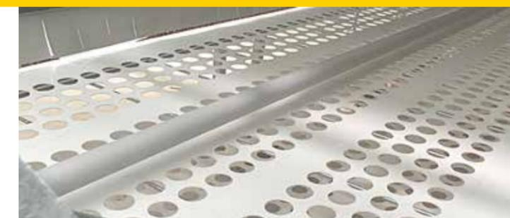
La raccolta delle uova avviene tramite un nastro da 500 mm, o 250 mm in caso di nidi a parete, che scorre al centro dei nidi automatici. Questo nastro in polipropilene è dotato di fori che mantengono ferme le uova durante lo scorrimento.
